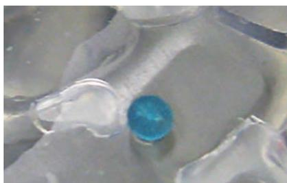
図2 SDME後にろ取した“青い液滴”(室温より少し高融点の溶媒を液滴として使用して加温抽出後、室温下で液滴を固化させるとろ過により抽出物を分取できる)
