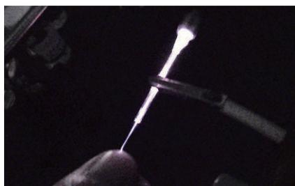
図1 指に照射したヘリウムマイクロプラズマ
