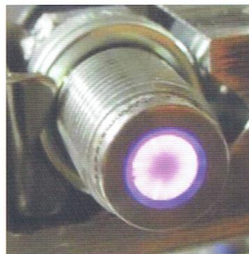
図2 放電しているプラズマアクチュエーターデバイス
