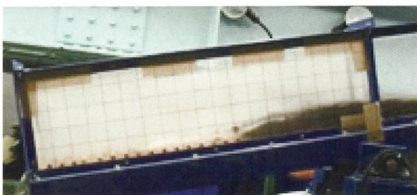
写真2 軽石で構成された土石流流下状況
