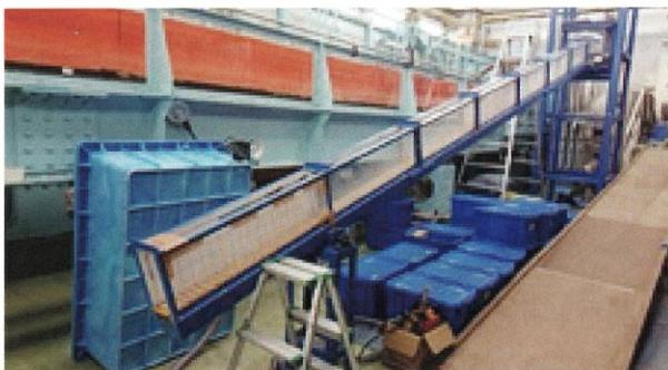
写真1 土石流実験水路
